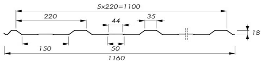
Das Trapezblech T-18 Plus (18/220) hat eine hohe Tragfähigkeit. Es kann sowohl für die Eindeckung von Dächern, als auch für die Wandverkleidung eingesetzt werden.
